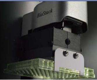
BioStack是一款结构小巧应用灵活的储板器，它可以和BioTek公司的微孔板洗板机、移液分液系统、微孔板检测系统以及成像系统相互整合。BioStack独特的板架设计，使其具有空前的孔板传输速度，大大增加了自动化操作的通量和工作效率。BioStack拥有一个可旋转的机械手，可以在水平或垂直方向和自动化系统进行完美对接，无论是实验平台还是封闭的操作空间均可以通过友好的仪器操作界面实现无缝对接。通过BioStack和405™ Touch、405™ LS、EL406™或MultiFlo™FX的对接，完成全自动的洗板或液体处理工作，并可以兼容24,48,96,384和1536孔板和其他高度不超过22mm的孔板。全新的BioStack还具有专利的去盖和加盖功能，非常适合高通量细胞水平的自动化分析操作。
